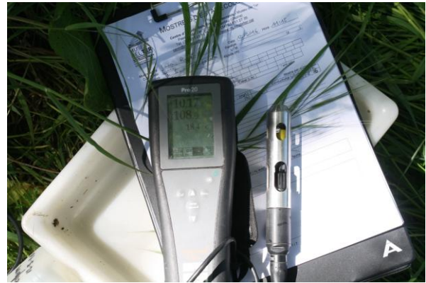
Figura 4. Sonda d'oxigen YSI Pro 20 per mesurar la temperatura i l'oxigen dissolt (en % de saturació i en mg/L)
